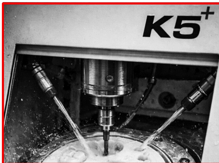
[Figura 10. Unidad de fresado (CAM).]
